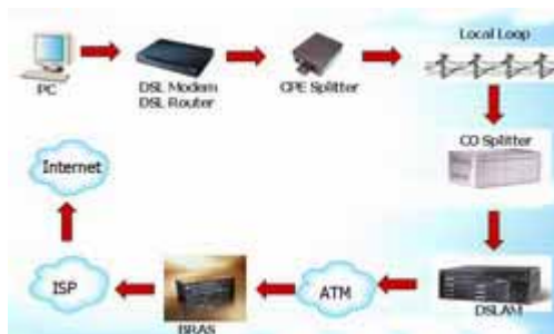
รูปที่ 10 แสดงการเชื่อมต่อจากลูกค้าไปหาระบบอินเทอร์เน็ตแบบละเอียด
