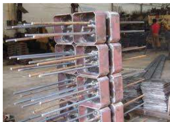
รูปที่ 3.28 แสดงหัวขู สำหรับใช้ติดปลายเสาเข็มที่ตอกดิน
