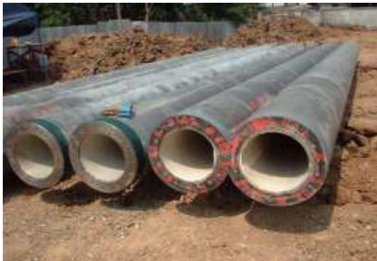
รูปที่ 3.27 แสดงเสาเข็มแรงเหวี่ยง (Spun Piles)
