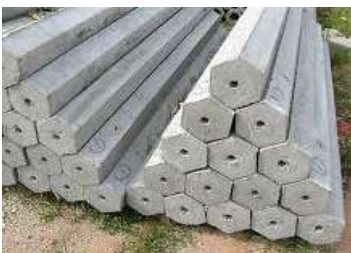
รูปที่ 3.25 แสดงเสาเข็มหกเหลี่ยม (ด้านหน้าตัดรองรับฐานราก)
