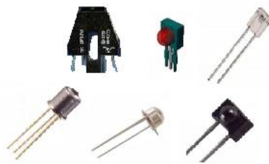
รูปที่ 6.1.21 ตัวอย่างของโฟโตทรานซิสเตอร์
